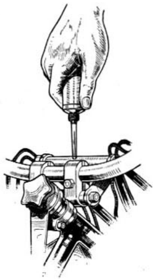
Comment utiliser la seringue livrée avec la machine pour le graissage à pression.
