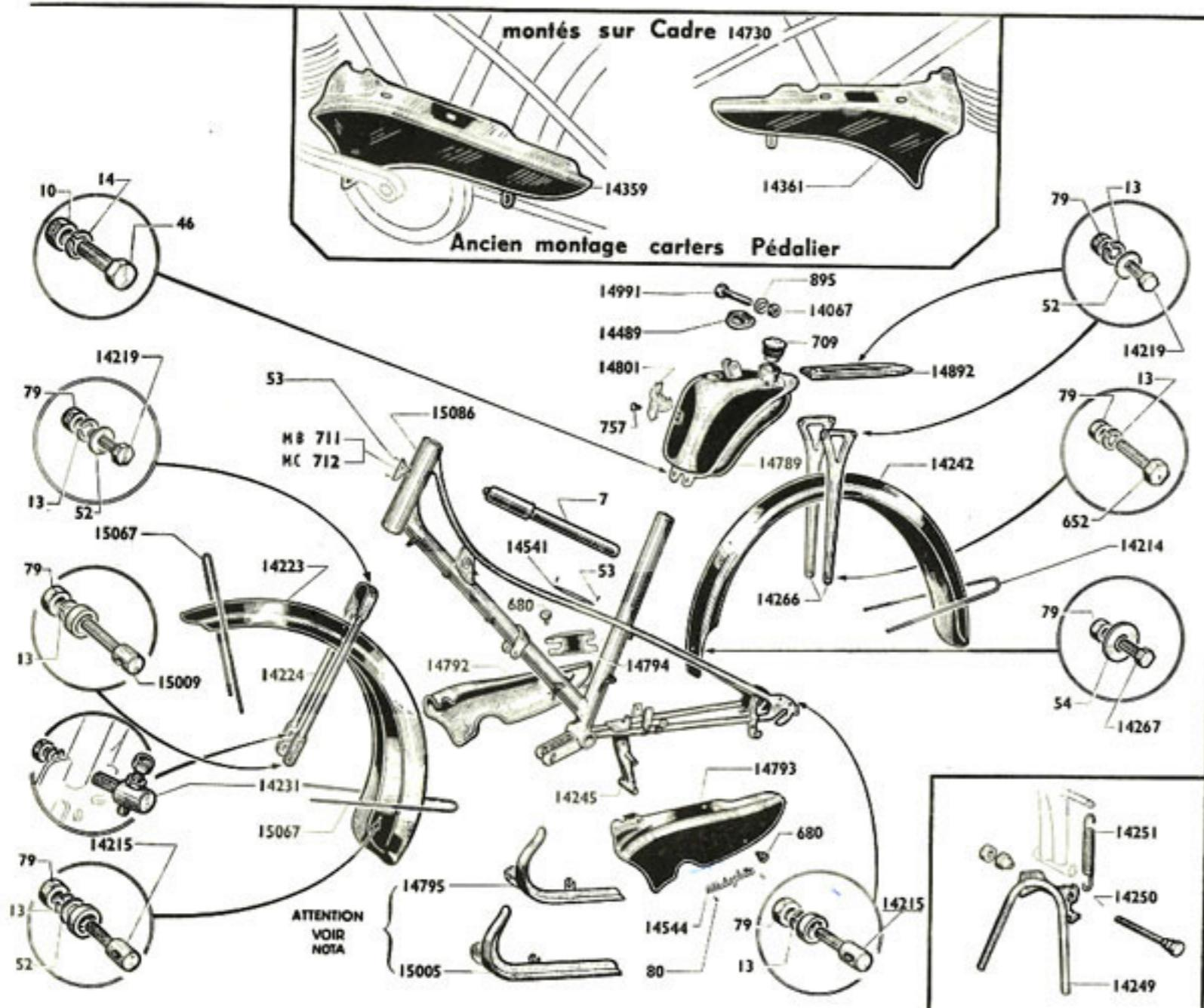
**NOTA.** - Le carter de protection de poulie N° 15005 se monte uniquement sur les machines AV 37 équipées d'un moteur AV 35 V.
