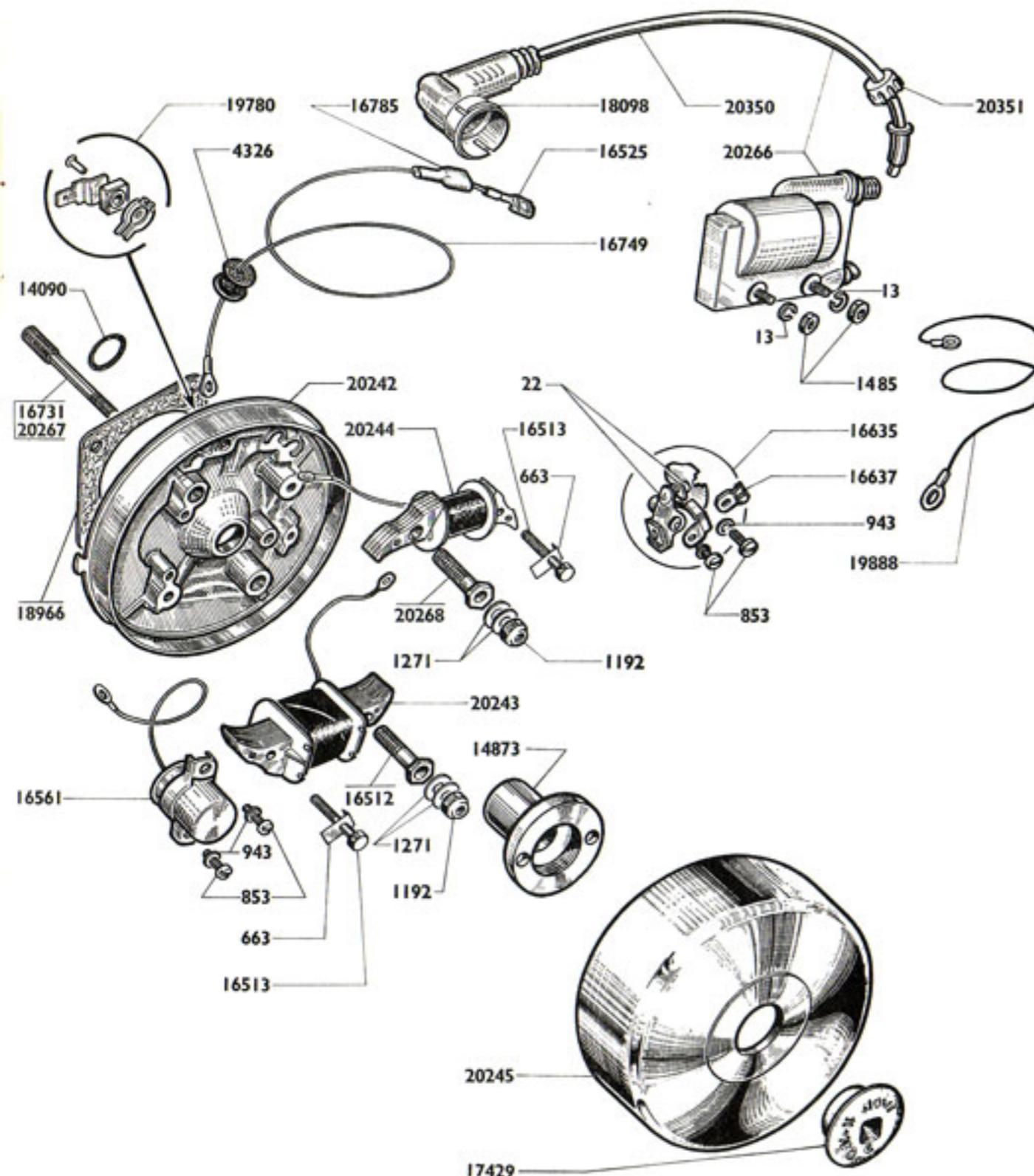
**VOLANT MAGNÉTIQUE 8 watts
