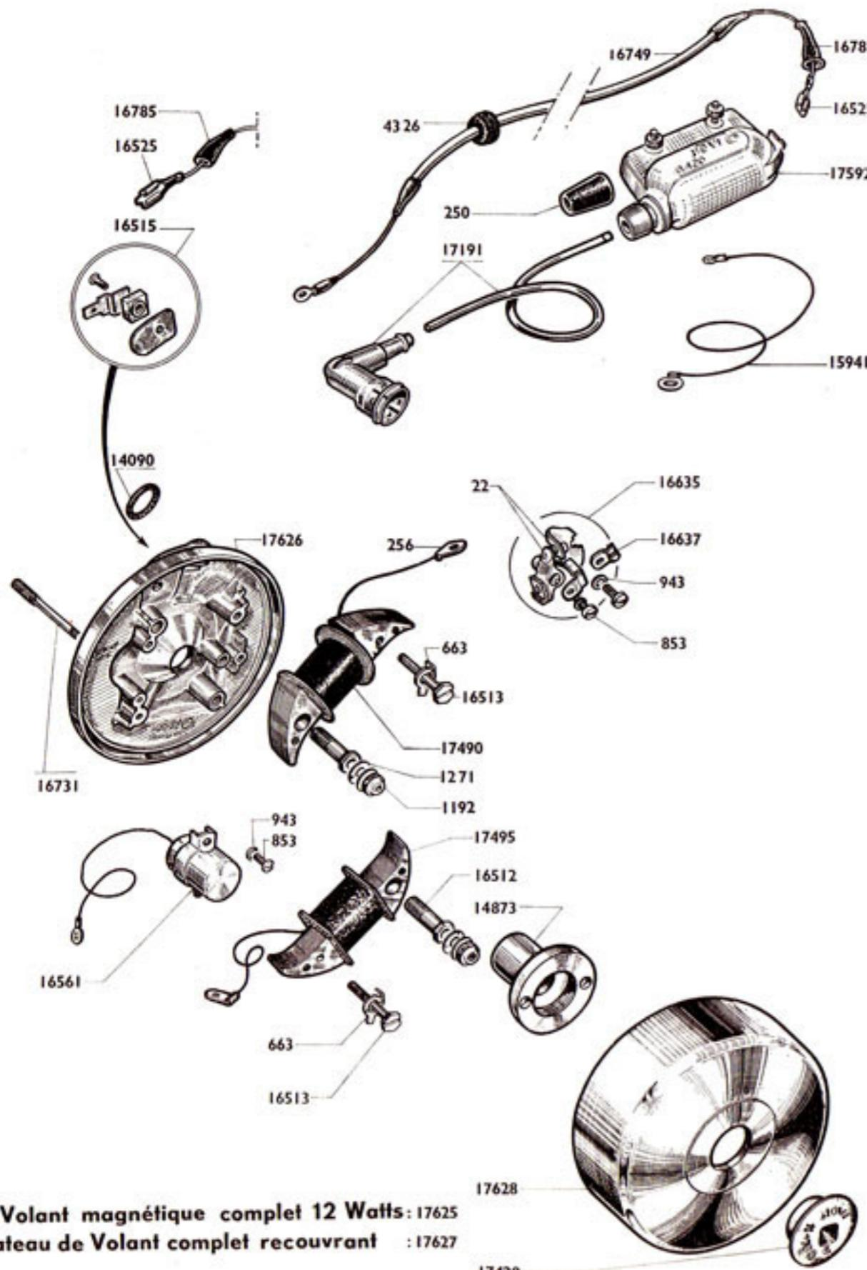
**Volant magnétique complet 12 Watts : 17625**
