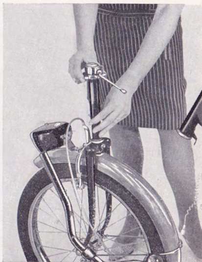
10 Revisser le volant de blocage sur le tube de direction.
