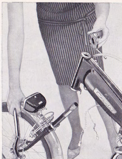
9 Sortir l'ensemble fourche-roue AV.
