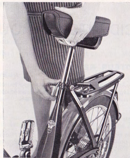
11 Desserrer le blocage rapide de selle et retirer celle-ci.
