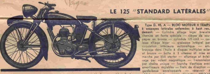
Type D. 45, A - BLOC MOTEUR 4 TEMPS à soupapes latérales enfermées à haut ren. dement. — Cylindre alliage léger breveté chemisé en fonte spéciale — sièges de souchemise en tonte speciale — sieges de soupapes an bronze — cylindrée 125 cm3 — culasse alliage léger — graissage intégral par
