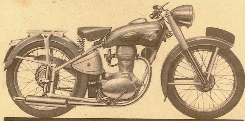
très puissants commandés l'un au guidon, l'autre par pédale au pied — roue arrière avec moyeu à broche permettant un démontage aisé sans toucher à la chaîne — pneus 25 x 3 — présentation émail couleur marron et beige.
