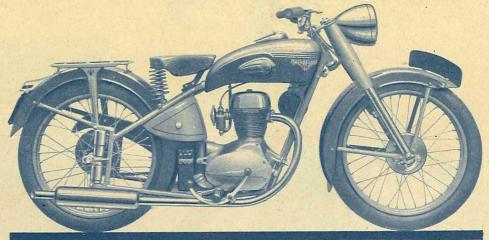
et de l'éclairage — réservoir à essence 10 litres environ — 2 freins à tambour très puissants commandés l'un au guidon, l'autre par pédale au pied — roue arrière avec moyeu à broche permettant un démontage aisé sans toucher à la chaîne - pneus vélomoteur de 25 × 3 - présentation émail couleur marron et beige.
