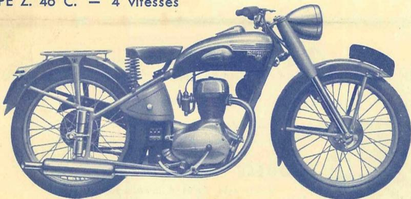
Bloc-moteur 4-temps à culbuteurs enfermés - commande des vitesses par sélecteur au pied - éclairage et avertisseur alimentés par volant magnétique, redresseur et batterie - roue arrière avec moyeu à broche - jantes et réservoir chromés - compteur kilométrique.
