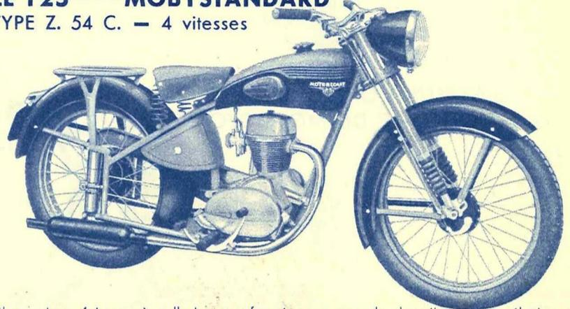
Bloc-moteur 4-temps à culbuteurs enfermés - commande des vitesses par sélecteur au pied - éclairage par volant magnétique.
