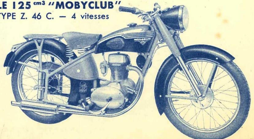
Bloc-moteur 4-temps à culbuteurs enfermés - commande des vitesses par sélecteur au pied - éclairage et avertisseur alimentés par volant magnétique, redresseur et batterie - roue arrière avec moyeu à broche - jantes et réservoir chromés - compteur kilométrique.
