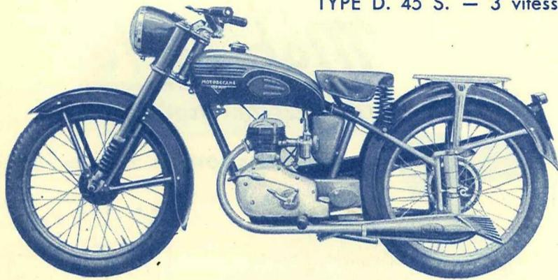
Bloc-moteur 4-temps à soupapes latérales enfermées à haut rendement - éclairage par volant magnétique.
