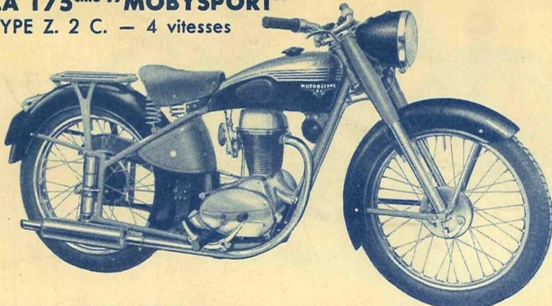
Bloc-moteur 4-temps à culbuteurs enfermés - graissage intégral par circulation intérieure automatique - commande de vitesses par sélecteur au pied - éclairage et avertisseur alimentés par volant magnétique, redresseur et batterie - roue arrière avec moyeu à broche - jantes et réservoir chromés - compteur kilométrique - pneus 25 x 3.
