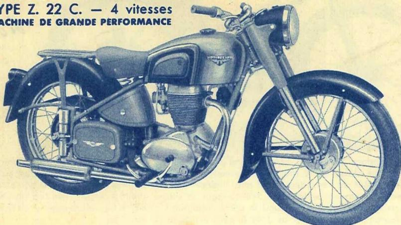
Mêmes caractéristiques que la Z 2 C mais bloc-moteur spécial à graissage sous pression par pompe - moyeux-freins monoblocs à broche de 150 AR - larges garde-boue enveloppants - pneu AR 25 x 3, pneu AV 25 x 3 ligné.
