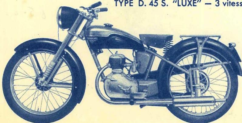
Bloc-moteur 4 temps à soupapes latérales enfermées à haut rendement - éclairage par volant magnétique - réservoir, jantes et pot d'échappement chromés.
