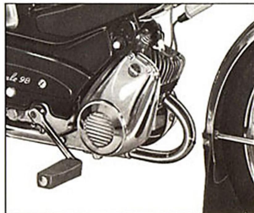
Moteur à cylindre et culasse carrés, ailetage à grande surface. Soufflante de refroidissement.
