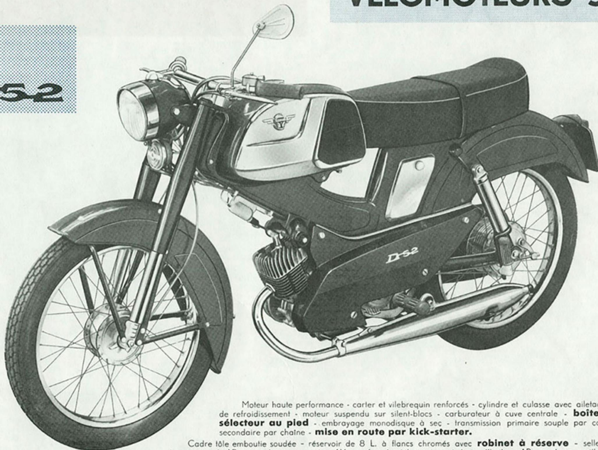
Moteur haute performance - carter et vilebrequin renforcés - cylindre et culasse avec ailetages à grande surface de refroidissement - moteur suspendu sur silent-blocs - carburateur à cuve centrale - **boîte 5 vitesses par sélecteur au pied** - embrayage monodisque à sec - transmission primaire souple par courroie - transmission secondaire par chaîne - **mise en route par kick-starter**.
