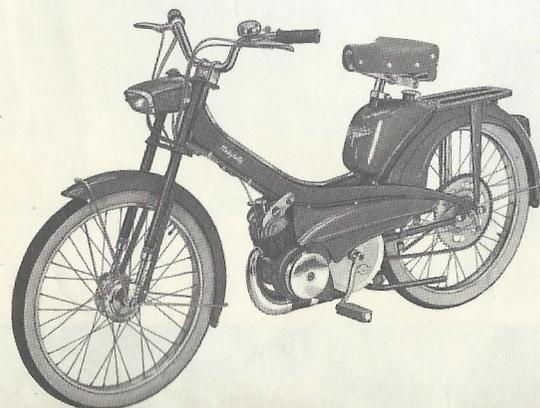
**MOBYLETTE "MOBYMATIC STANDARD" TYPE AV 48.** Moteur à double embrayage automatique "DIMOBY" et changement de vitesse automatique "MOBYMATIC" - cadre tôle emboutie - réservoir de 3 L. 500 - freins AV et AR monoblocs - fourche télescopique - selle Confort - pneumatiques de 23 x 2 à flancs blancs - timbre avertisseur.
