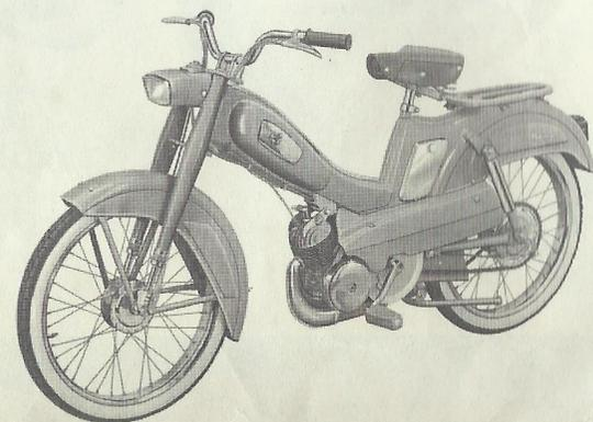
**MOBYLETTE "MONOLUXE" TYPE AV 65.** Moteur à double embrayage automatique "DIMOBY" - châssis-coque intégral formant réservoir d'essence (5 L.) - boîte à outils incorporée - suspension AV par fourche télescopique - AR par bras oscillant - selle Confort - pneumatiques 2,25 x 18 à flancs blancs - moyeux-freins monoblocs : AV 90  $\frac{mm}{m}$ , AR 100  $\frac{mm}{m}$  - garde-boue profonds à flasques de protection - timbre avertisseur.
