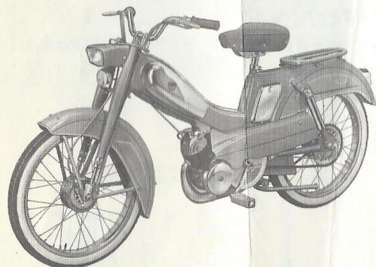
**MOBYLETTE "MONO GRAND LUXE" TYPE AV 85.** Moteur à double embrayage automatique "DIMOBY" châssis-coque intégral formant réservoir d'essence (5 L.) - boîte à outils incorporée - suspension AV par fourche télescopique - AR par bras oscillant - selle Grand Confort - pneumatiques 2,25 x 18 à flancs blancs - moyeux-freins monoblocs : AV 90  $\frac{m}{m}$ , AR 100  $\frac{m}{m}$  - garde-boue profonds avec flasques de protection - phare avec compteur de vitesse incorporé - avertisseur électrique.
