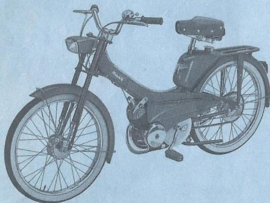
**MOBYLETTE "STANDARD TÉLESCOPIQUE" TYPE AV 44.** Moteur à double embrayage automatique "DIMOBY" - cadre tôle emboutie - réservoir de 3 L. 500 - freins AV et AR monoblocs - fourche télescopique - selle Confort - pneumatiques de 23 x 2 à flancs blancs - timbre avertisseur.
