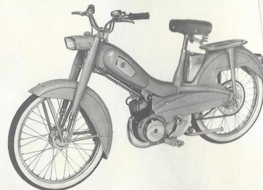
**MOBYLETTE "MOBYMATIC-SUPER" TYPE AV 79.** Moteur à double embrayage automatique "DIMOBY" et changement de vitesse automatique "MOBYMATIC" - châssis coque formant réservoir (5 L.) - fourche télescopique - selle Confort - pneumatiques de 23 x 2 à flancs blancs - freins AV et AR monoblocs - garde-boue profonds avec flasques de protection - timbre avertisseur.
