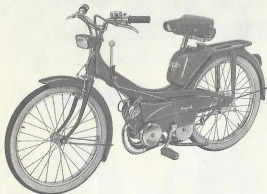
**MOBYLETTE "COURROIE-GALET" TYPE BG 43.** Moteur à double embrayage automatique "DIMOBY" - cadre tôle emboutie - transmission par courroie-galet de grand diamètre - porte-galet mobile assurant la mise en bicyclette instantanée par commande unique du levier de relevage du galet et du robinet d'essence (breveté S.G.D.G.) - réservoir de 3 L. 500 - moyeu-frein tambour AR - pneumatiques de 23 x 2 - selle Confort - timbre avertisseur.
