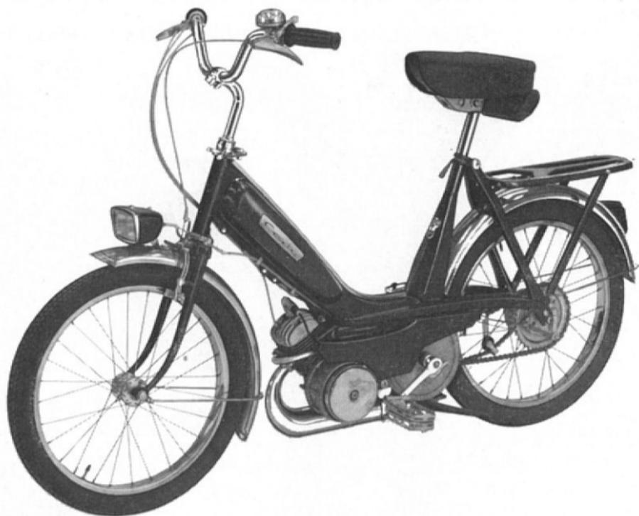
Cadre tôle emboutie, réservoir 2,8 l., poignées de portage, pneumatiques 2×16 (20×2) R, dispositif de mise en bicyclette à enclenchement instantané, frein AR monobloc. — Moteur 49,9 cm<sup>3</sup> ISODYNE, cylindre aluminium chromé dur, embrayage automatique double, transmission par courroie crantée et chaîne, starter automatique, commande des gaz par poignée tournante, dispositif automatique de sécurité coupant les gaz au freinage.
