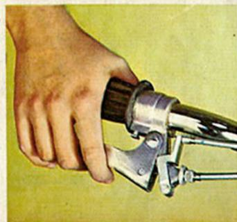
Commande des gaz par poignée tournante — **dispositif de sécurité coupant les gaz au freinage.**
