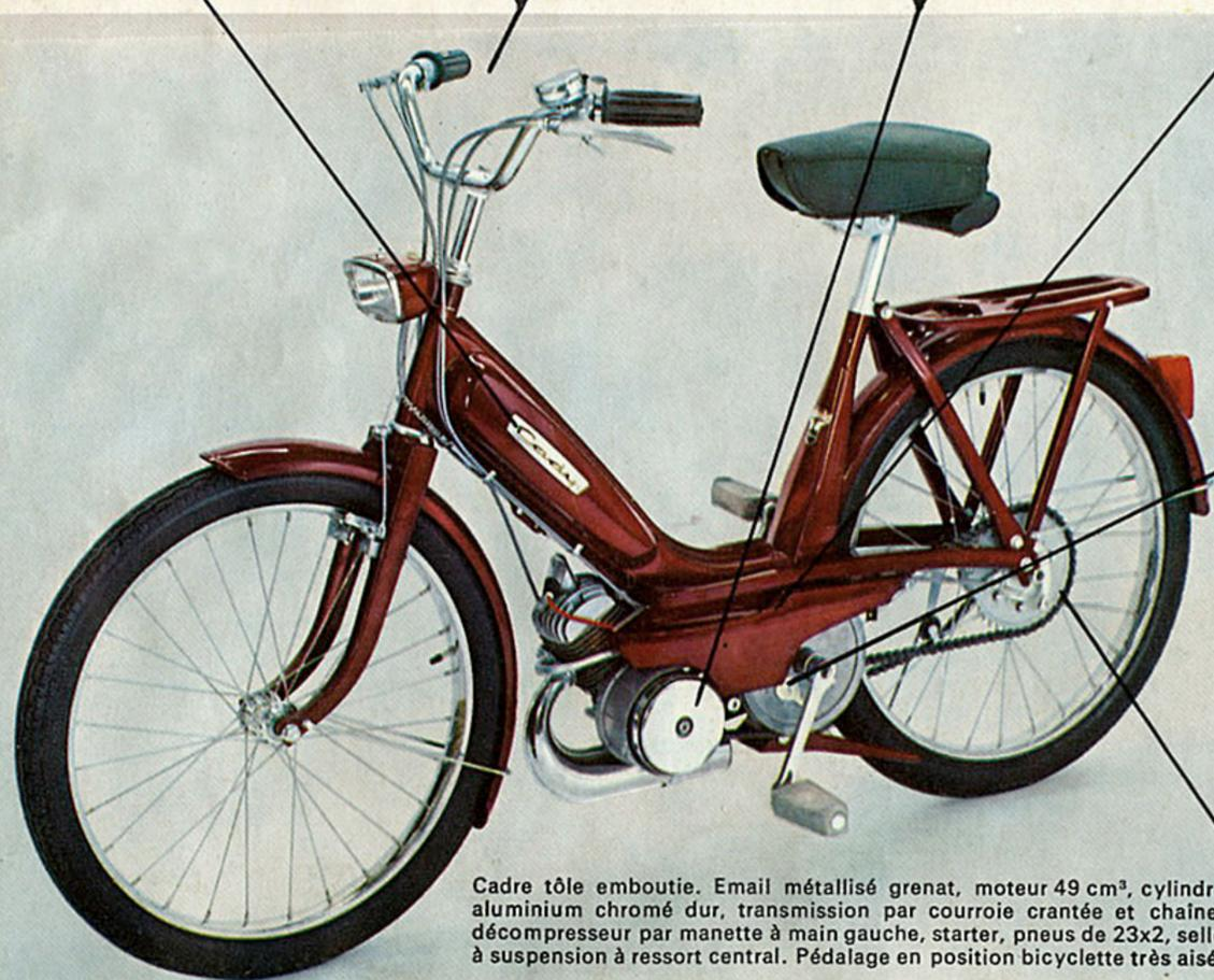
Cadre tôle emboutie. Email métallisé grenat, moteur 49 cm<sup>3</sup>, cylindre aluminium chromé dur, transmission par courroie crantée et chaîne, décompresseur par manette à main gauche, starter, pneus de 23x2, selle à suspension à ressort central. Pédalage en position bicyclette très aisé.
