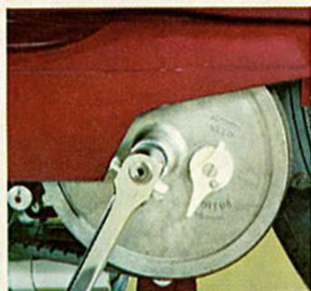
Mise en bicyclette — Mise en moteur: dispositif d'enclenchement instantané.
