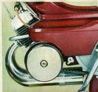
Moteur ISODYNE (puissance constante): montée des côtes jusqu'à 10% sans pédaler. Embayage automatique double.
