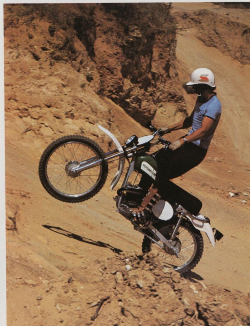
par un bras oscillant et des amortisseurs télescopiques hydrauliques réglables en plusieurs positions; ça c'est bien quand on part à l'aventure dans la nature. Le D 55 TT freine tambour battant, il est muni à l'avant comme à l'arrière de freins à tambour de 120 mm de diamètre. Et ses pneus spéciaux tous terrains sont musclés et accrocheurs. Avant : 2,50 x 21. Arrière : 3,00 x 18.
