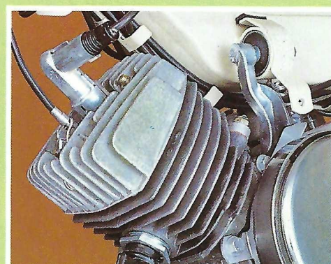
Suspension moteur par silentblocs
