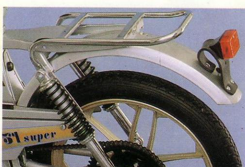
Amortisseurs hydrauliques - Feu AR monté souple - Boîte à outils incorporée sous la selle
