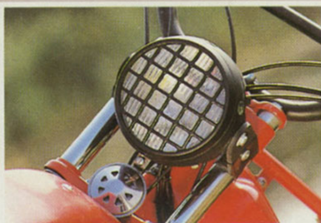
Eclairage à iode avec grille de protection
