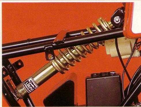
Amortisseur central hydraulique intégré à l'intérieur du cadre - Course 65 mm pour 100 mm de débattement à la roue
