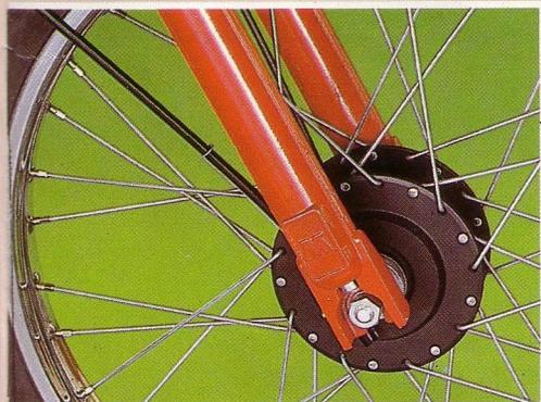
Fourche télescopique hydraulique, fourreau inférieur en alliage léger moulé
