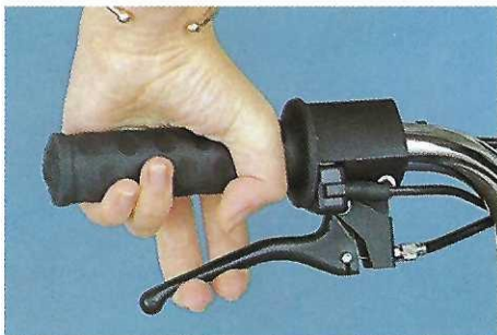
Poignée à double action - commande l'embrayage et le décompresseur - grande facilité de mise en route.
