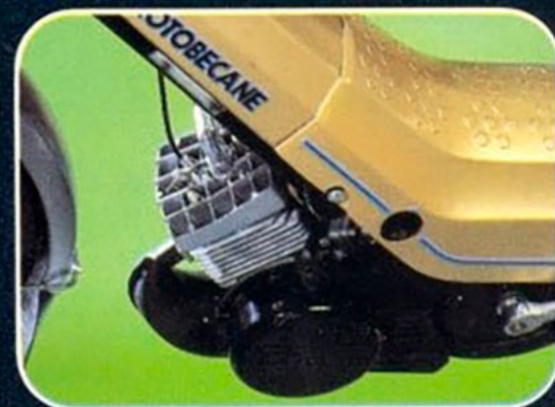
Moteur AV 10 - Culasse "Nid d'Abeille" - Parties tournantes carterisées - Robinet à réserve encastré.
