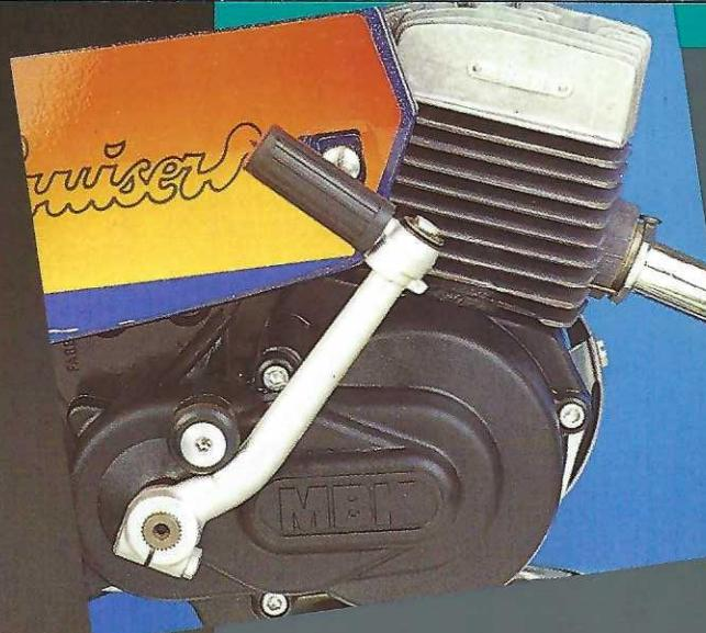
Kick de mise en route du moteur actionné vers l'avant.
