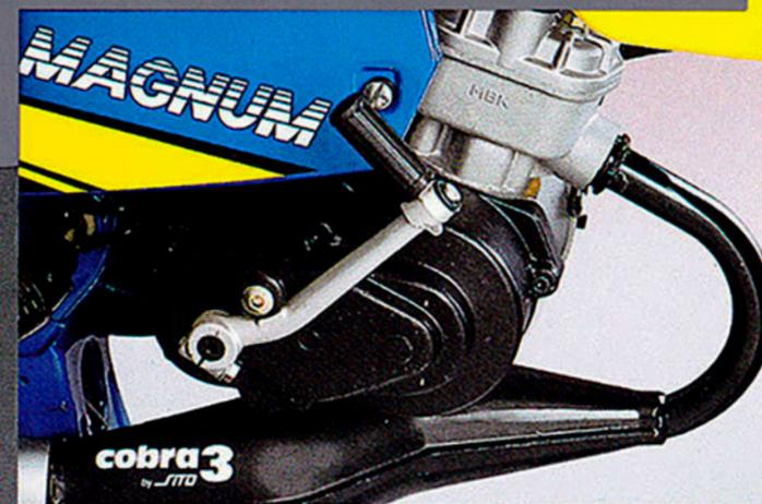
Kick de mise en route du moteur actionné vers l'avant. L'opération peut s'effectuer roues sur le sol, pilote en selle.
