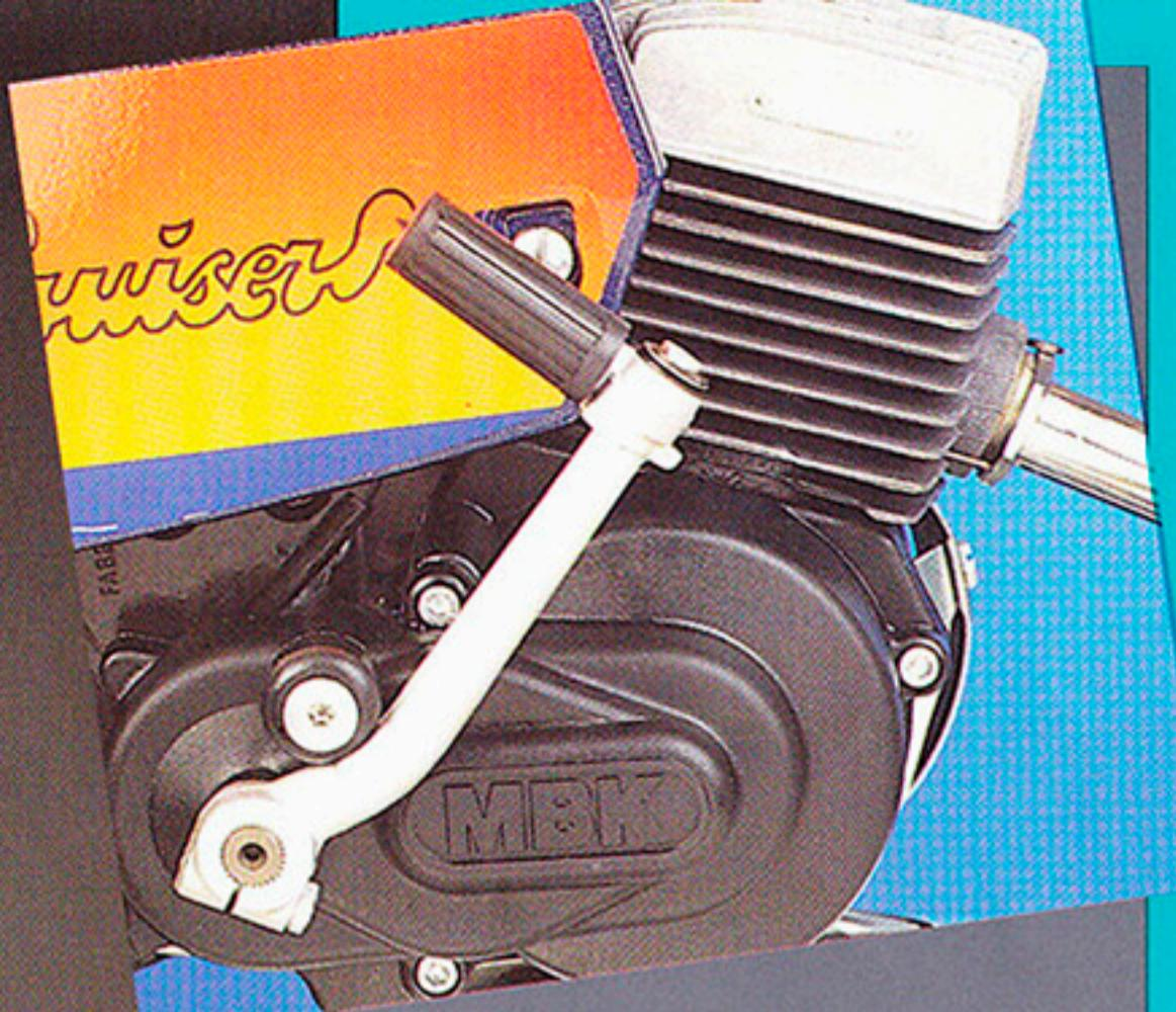
Kick de mise en route du moteur actionné vers l'avant.
