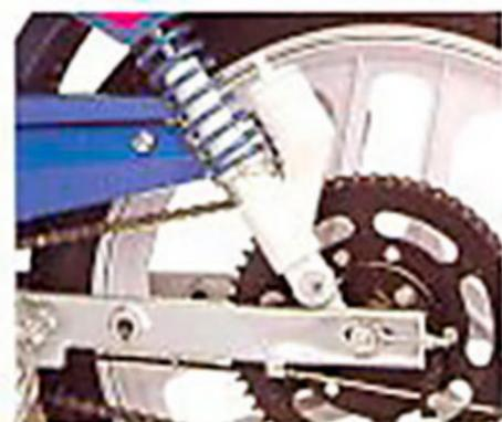
**Bras oscillant rectangulaire, amortisseurs à gaz avec bonbonne séparée.** Une plus grande rigidité, donc une tenue de route supérieure en ville comme en circuit, et par conséquent une plus grande sécurité.
