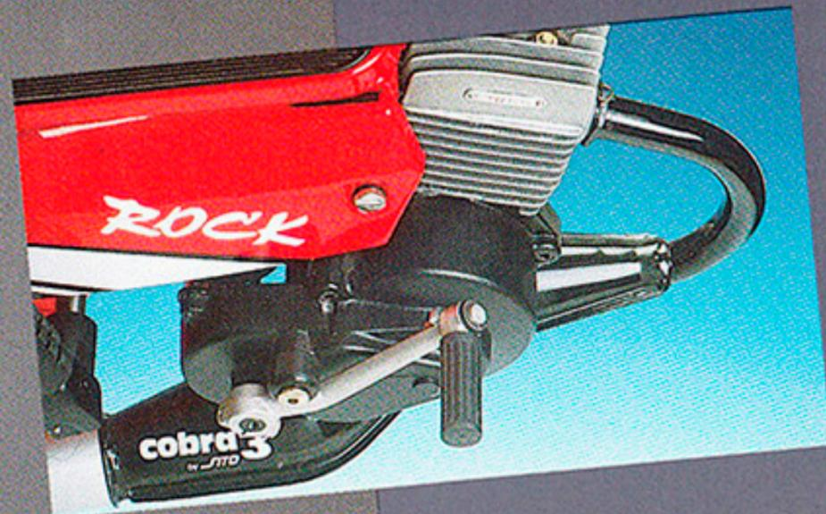
Kick de mise en route du moteur actionné vers l'avant. L'opération peut s'effectuer roues sur le sol, pilote en selle.
