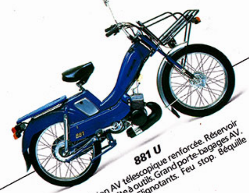
88 Suspension AV télescopique. Suspension AR. Réservoir de 5 litres. Boîte à outils. Compte-tours.
