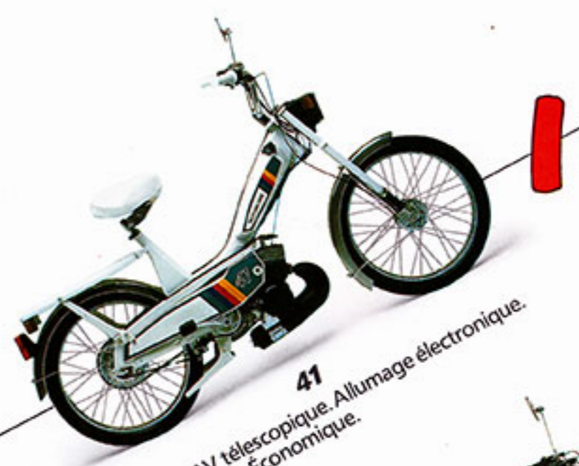
ZX 50 Kick. Amortisseur monocross à précharge d'air. Suspension AV à grand débattement. Graissage séparé par pompe à huile. Carburateur de 14 mm. Compte-tours. Clé de contact.
