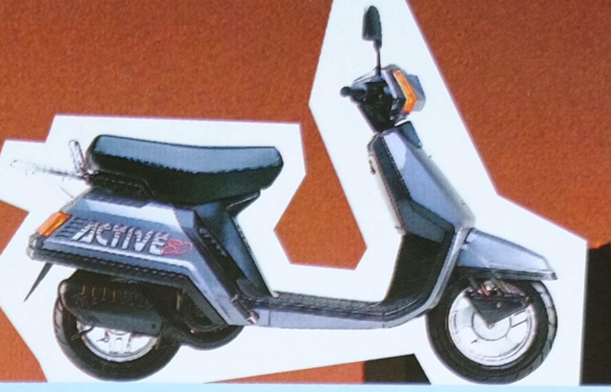
**ACTIVE 80**: Démarrage électrique ou kick. Graissage séparé par pompe à huile. Coffre AV. Compteur/compte-tours. Clignotants. Jauge d'essence. Antivol couplé à la clé de contact. 2 rétroviseurs. Selle biplace. Repose-pieds passager. Un large choix d'accessoires. Accessible aux permis voitures.
