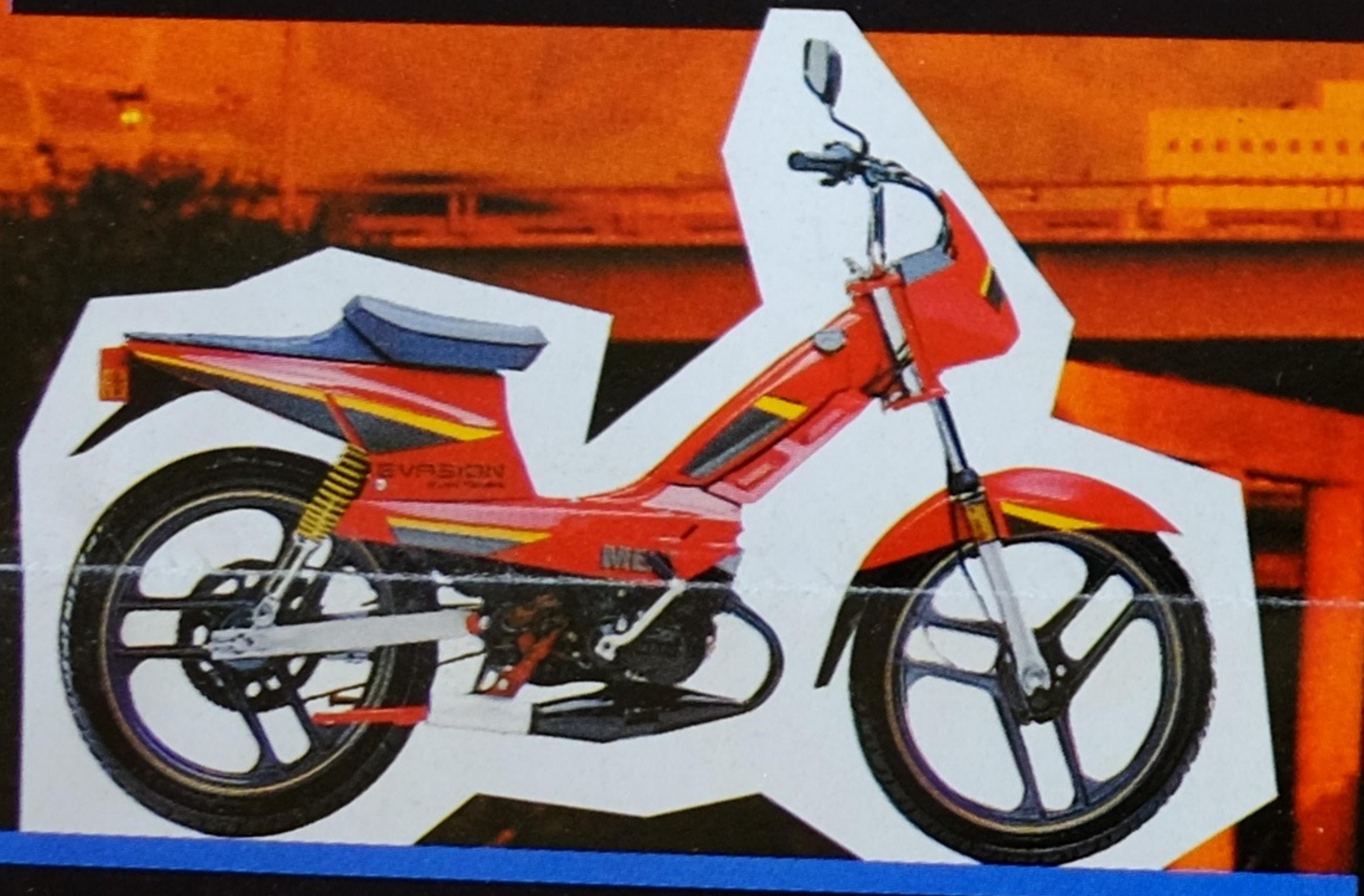
**EVASION**: Bras oscillant rectangulaire. Roues à bâtons en alu. Kick. Projecteur haute luminosité. Repose-pieds repliables. Pneus hautes performances. Feu stop. Pré-équipement clignotants. Compte-tours, porte-bagages et béquille latérale en option.
