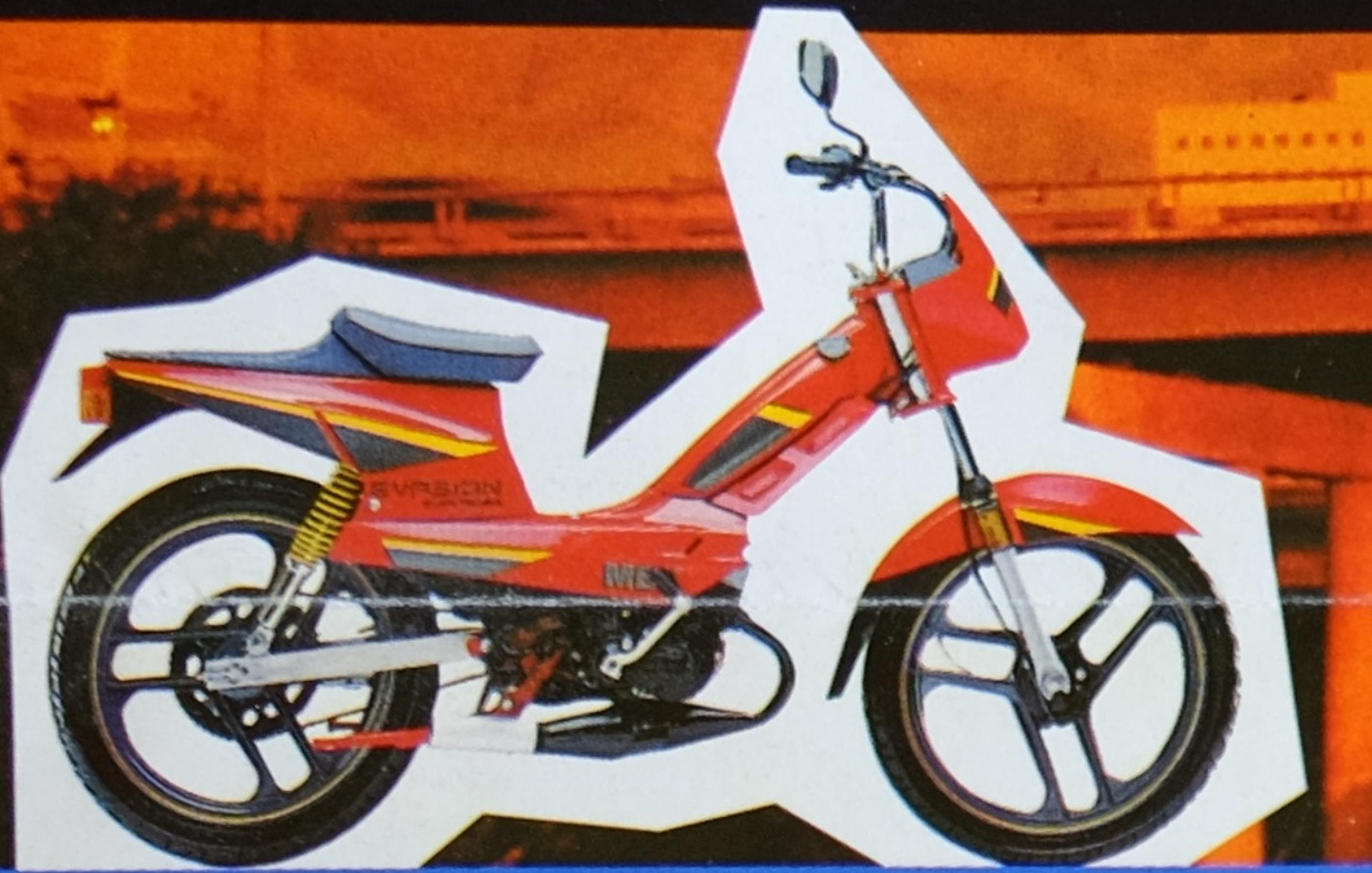
**EVASION**: Bras oscillant rectangulaire. Roues à bâtons en alu. Kick. Projecteur haute luminosité. Repose-pieds repliables. Pneus hautes performances. Feu stop. Pré-équipement clignotants. Compte-tours, porte-bagages et béquille latérale en option.
