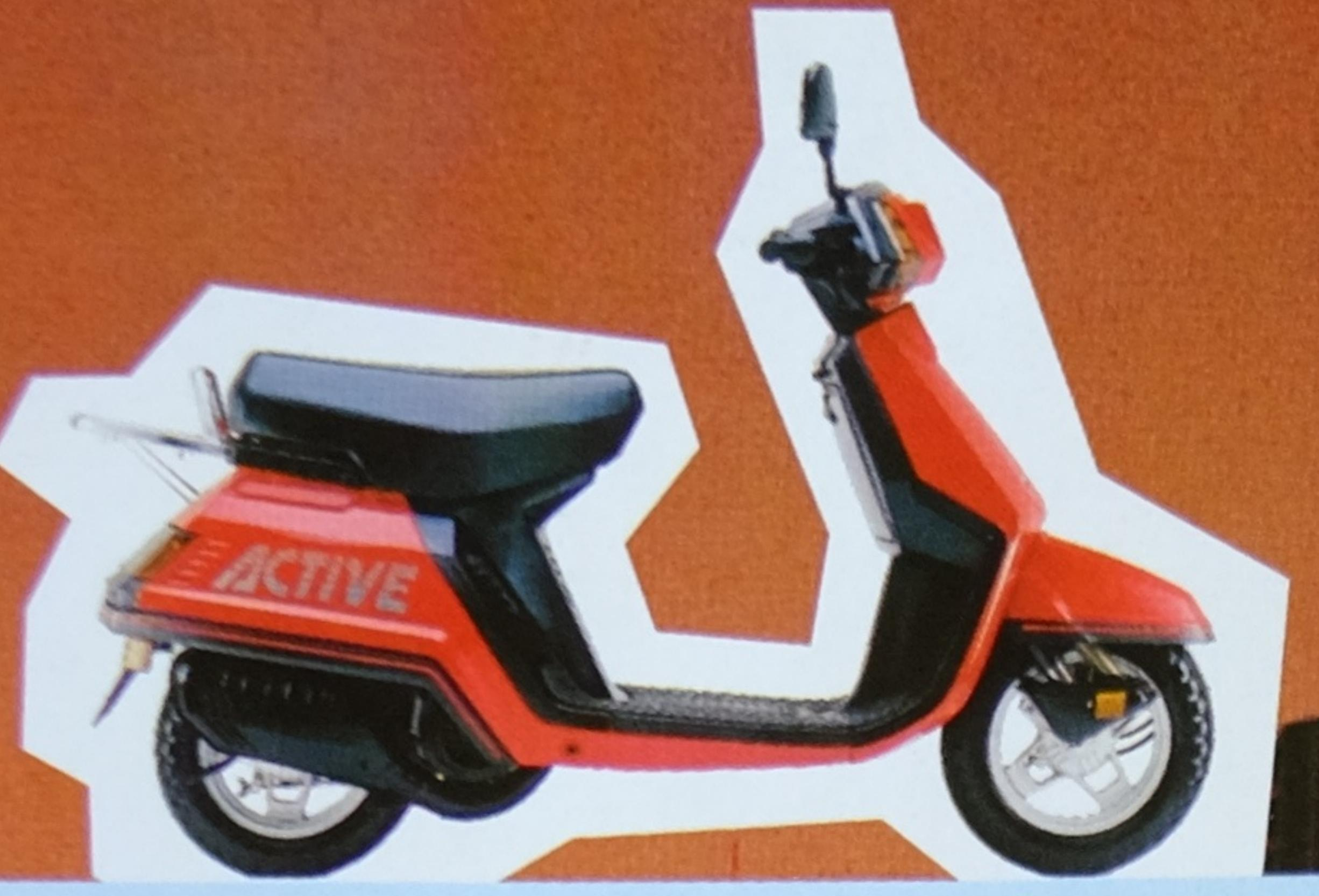
**ACTIVE 50**: Démarrage électrique ou kick. Graissage séparé par pompe à huile. Coffre AV. Compteur/compte-tours. Clignotants. Jauge d'essence. Antivol couplé à la clé de contact. 2 rétroviseurs. Selle biplace.
