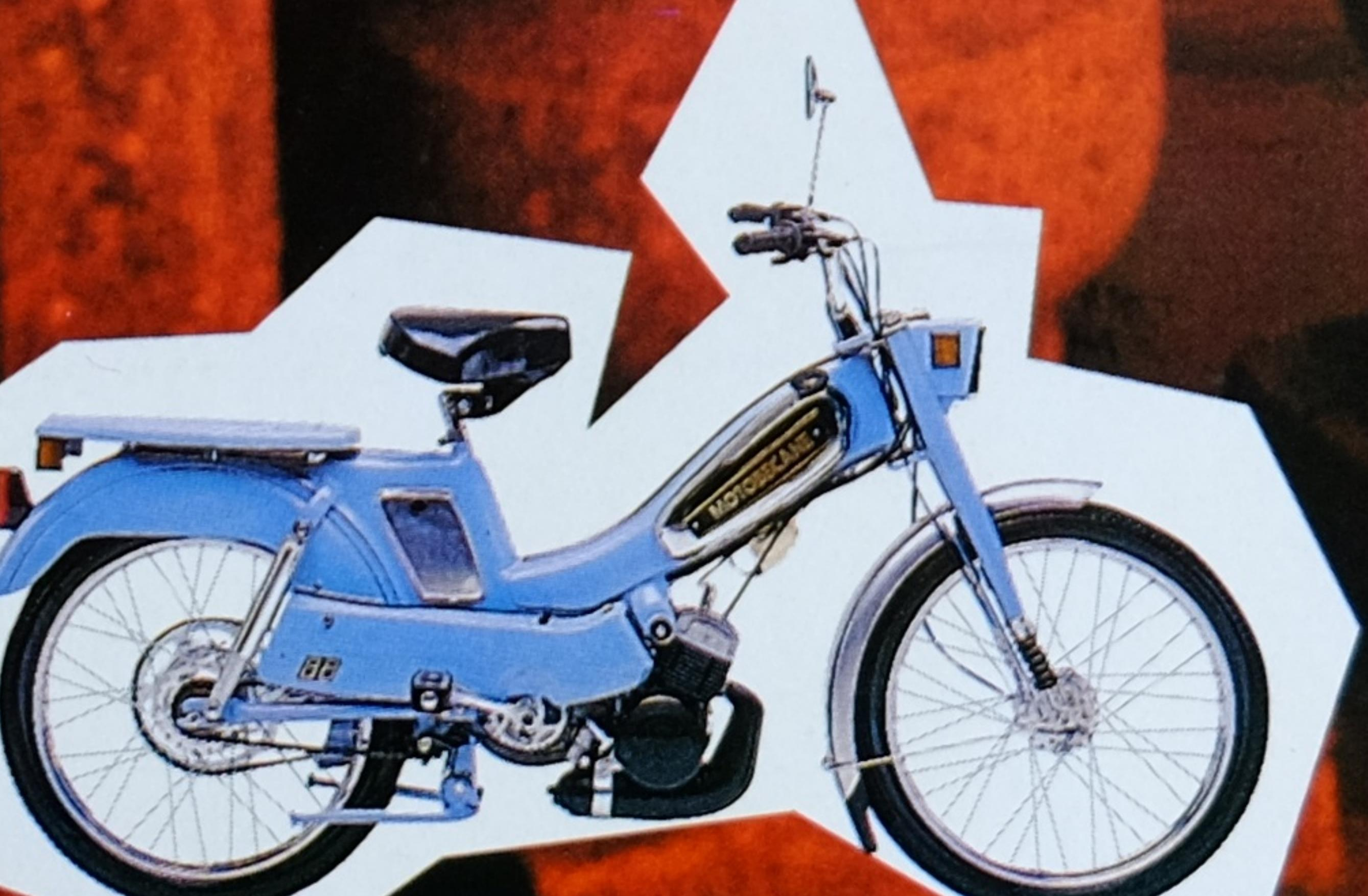
**88**: Suspension AV télescopique. Suspension AR. Réservoir de grande capacité. Boîte à outils. Compteur.
