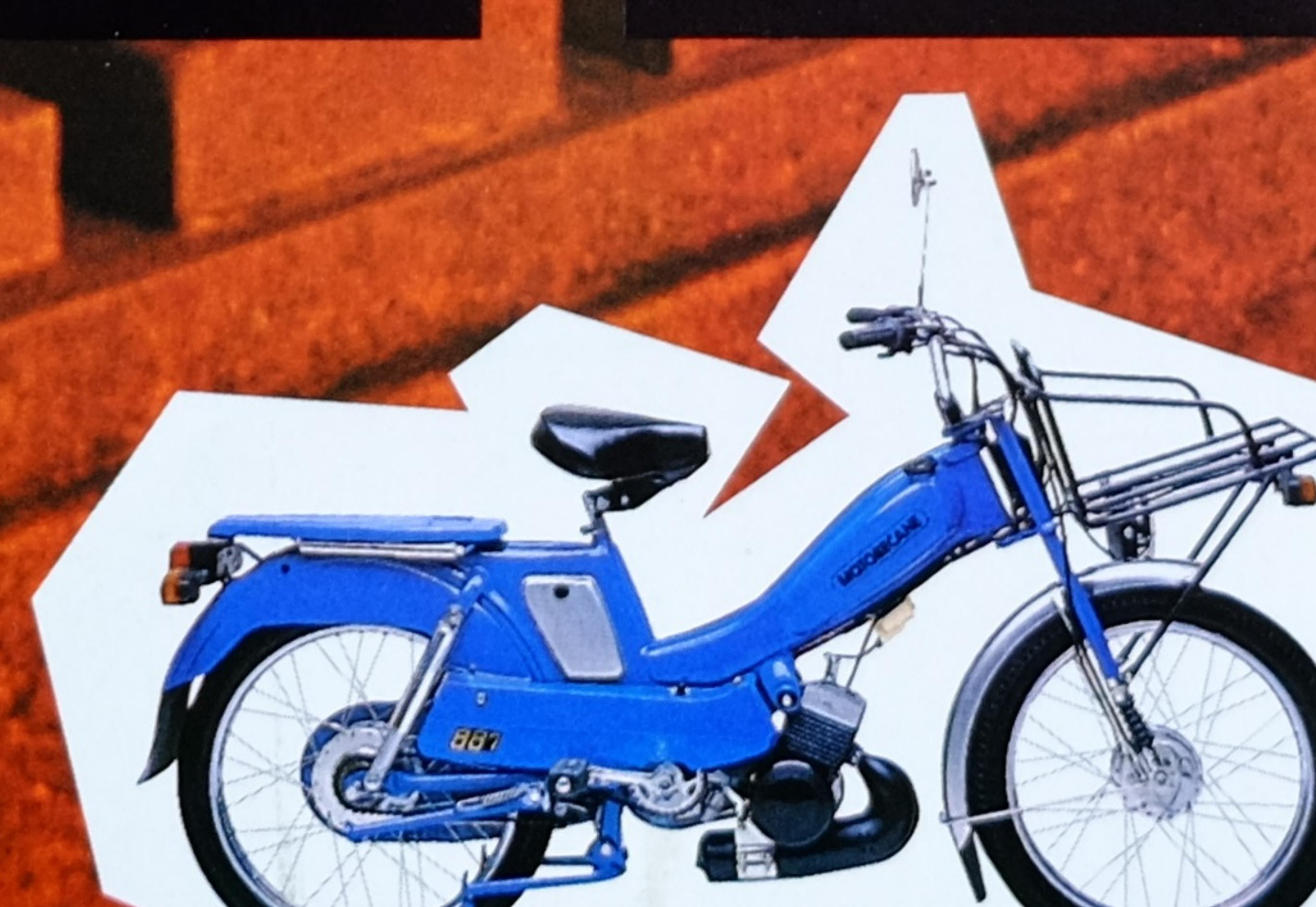
**881 U**: Suspension AV télescopique renforcée. Réservoir de grande capacité.
