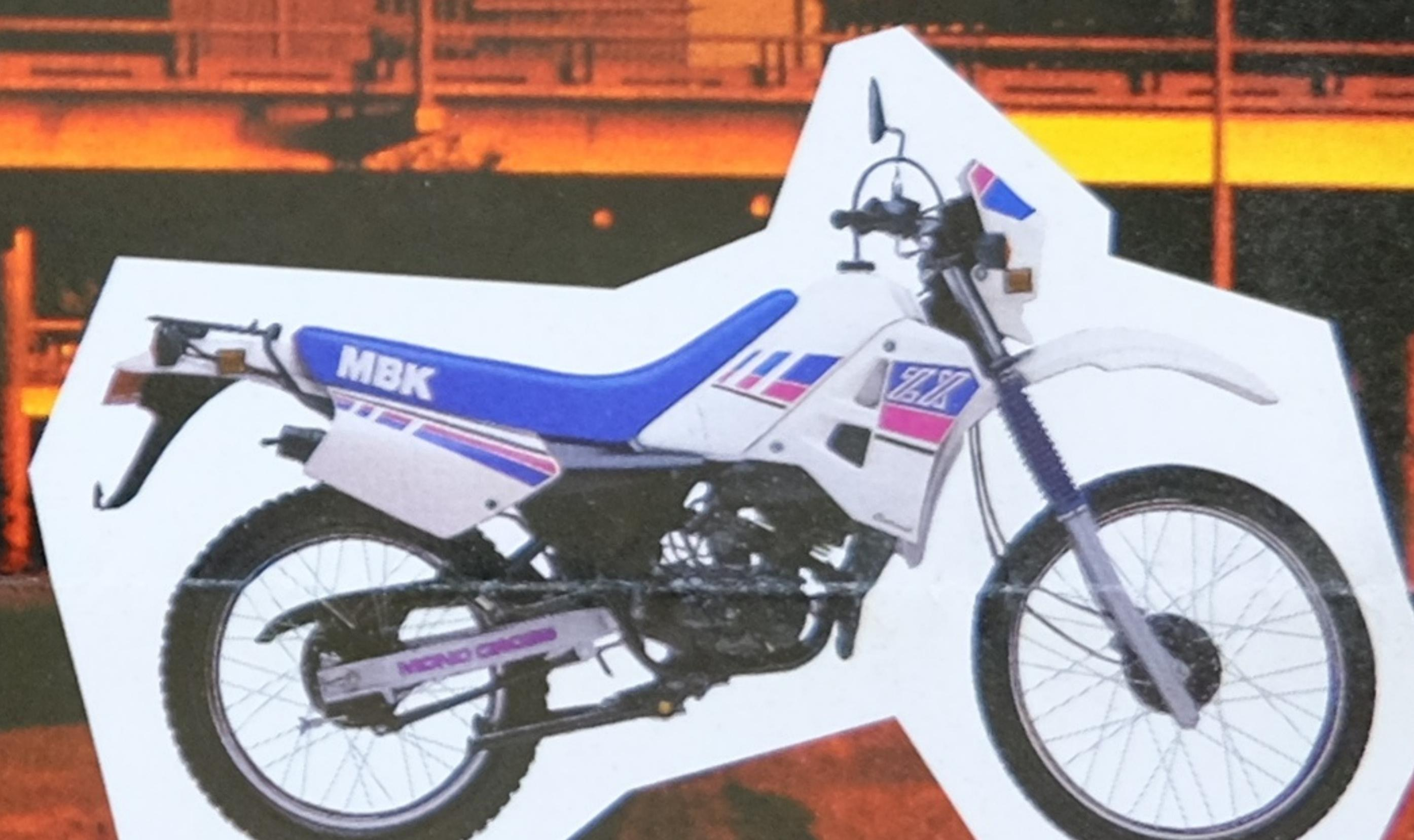
**ZX 50**: Kick. Amortisseur monocross à précharge d'air. Suspension AV à grand débattement. Graissage séparé par pompe à huile. Carburateur de 14 mm. Compteur. Clé de contact. Clignotants.
