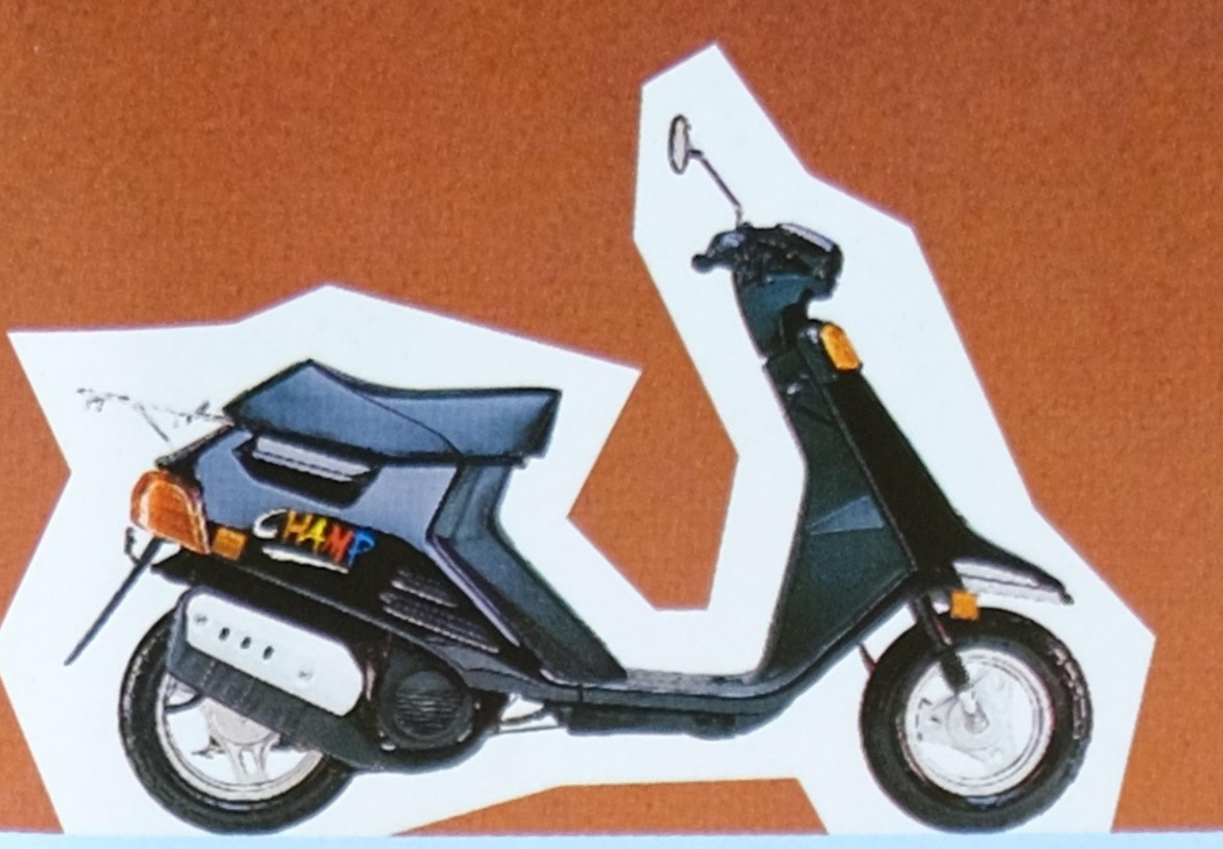
**CHAMP**: Démarrage électrique ou kick. Graissage séparé par pompe à huile. Jauge d'essence électrique. Antivol couplé à la clé de contact. Clignotants.
