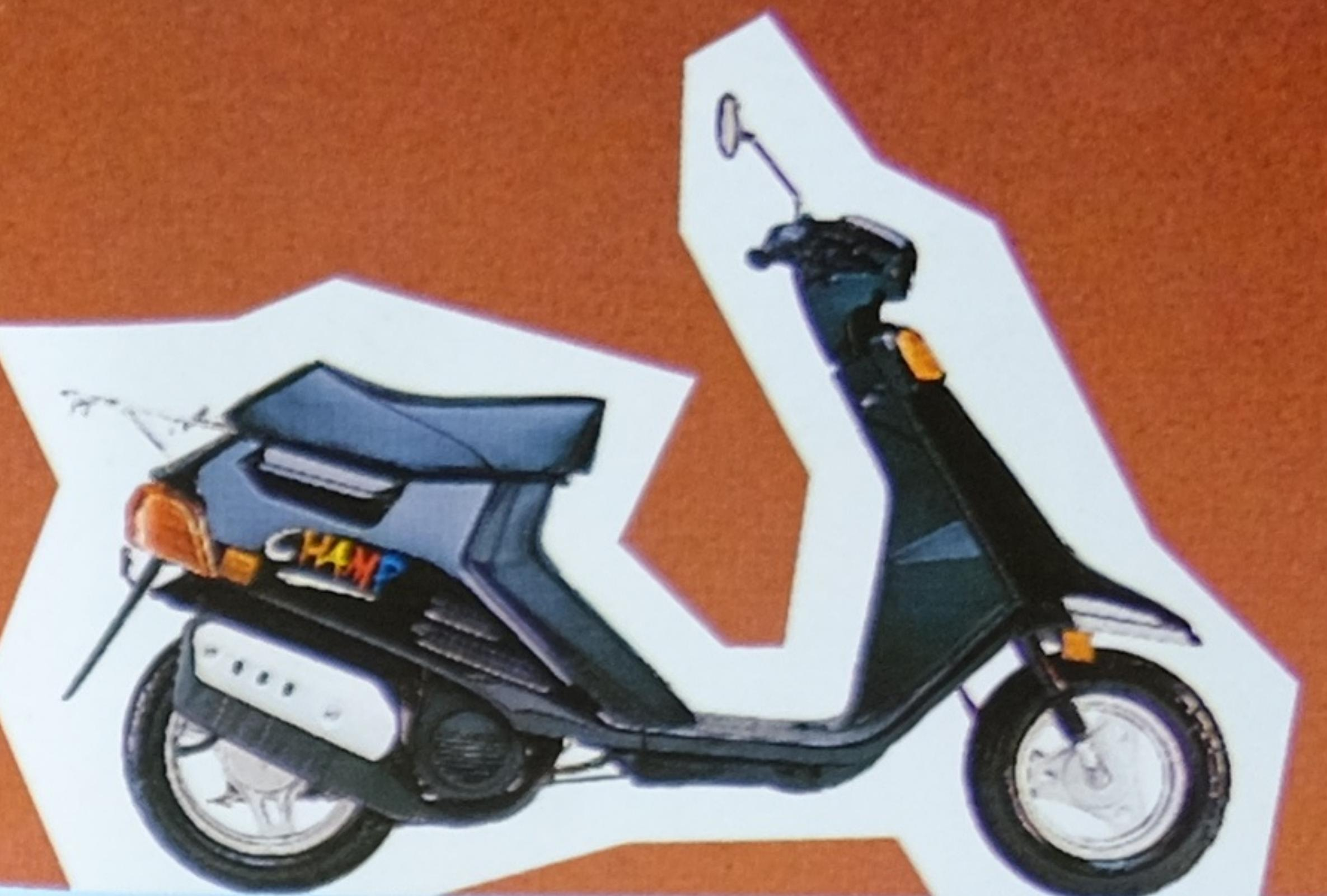
**CHAMP**: Démarrage électrique ou kick. Graissage séparé par pompe à huile. Jauge d'essence électrique. Antivol couplé à la clé de contact. Clignotants.
