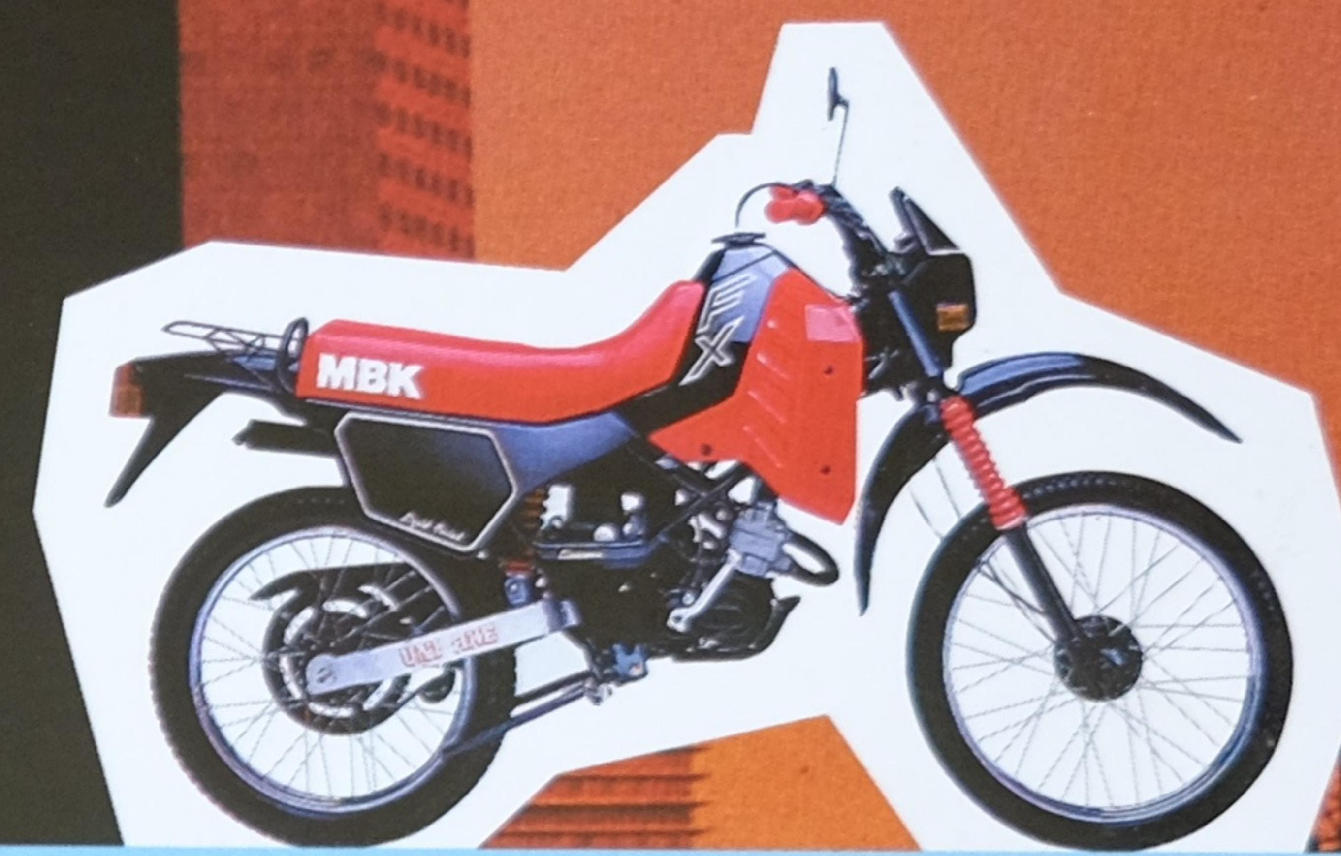
**FX 50 K**: Kick. Mono-amortisseur système UNI-AXE. Refroidissement liquide "AFS". Carburateur de 14 mm. Bras oscillant rectangulaire. Compteur. Compte-tours en option.
