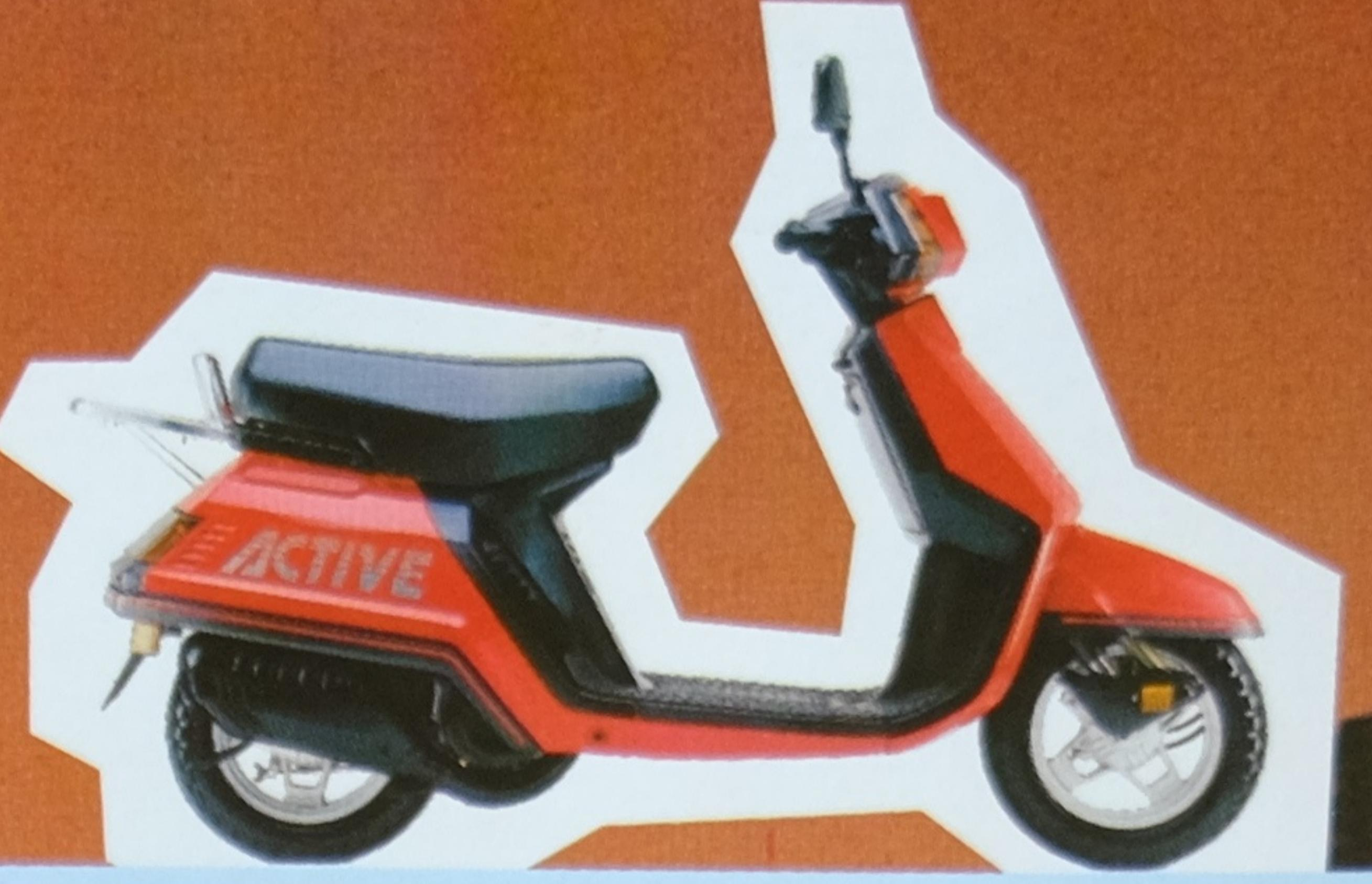
**ACTIVE 50**: Démarrage électrique ou kick. Graissage séparé par pompe à huile. Coffre AV. Compteur/compte-tours. Clignotants. Jauge d'essence. Antivol couplé à la clé de contact. 2 rétroviseurs. Selle biplace. Un large choix d'accessoires.
