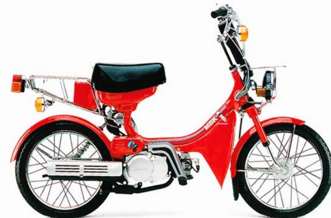
Graissage séparé. Transmission par cardan. Feu stop. Clignotants. 2 porte-bagages. Jupe protectrice AV. Contacteur à clé. Repose pieds.
