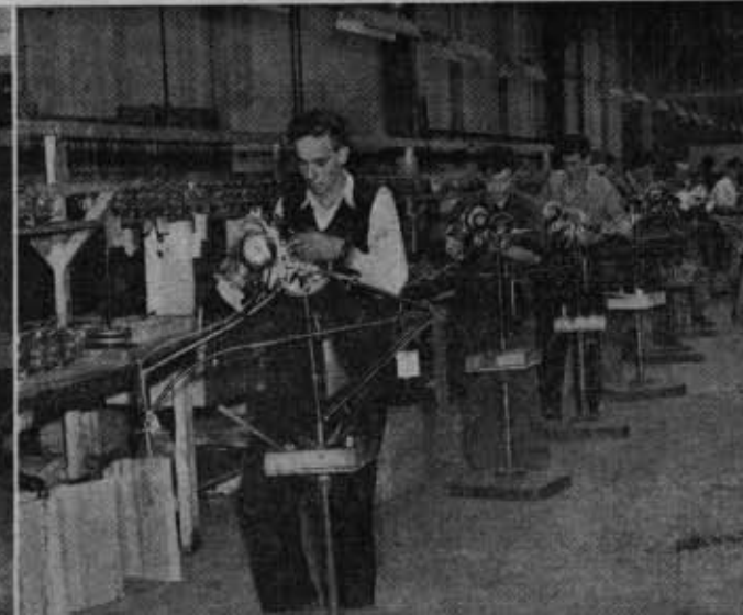
5. Mise en place du moteur et du pédalier sur le cadre. Chaque ouvrier dispose d'un support à pivot engagé dans le tube de selle. Une étagère contient les outils nécessaires.
