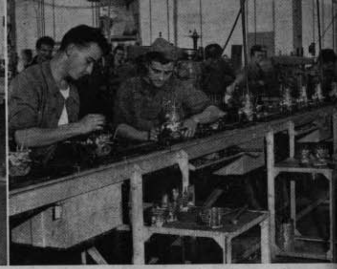
3. Une des chaînes de montage des moteurs. Au premier plan à gauche on assemble les carters ; ensuite on monte le cylindre, puis la culasse et les moteurs arrivent terminés à l'extrémité de la chaîne que l'on aperçoit à droite.
