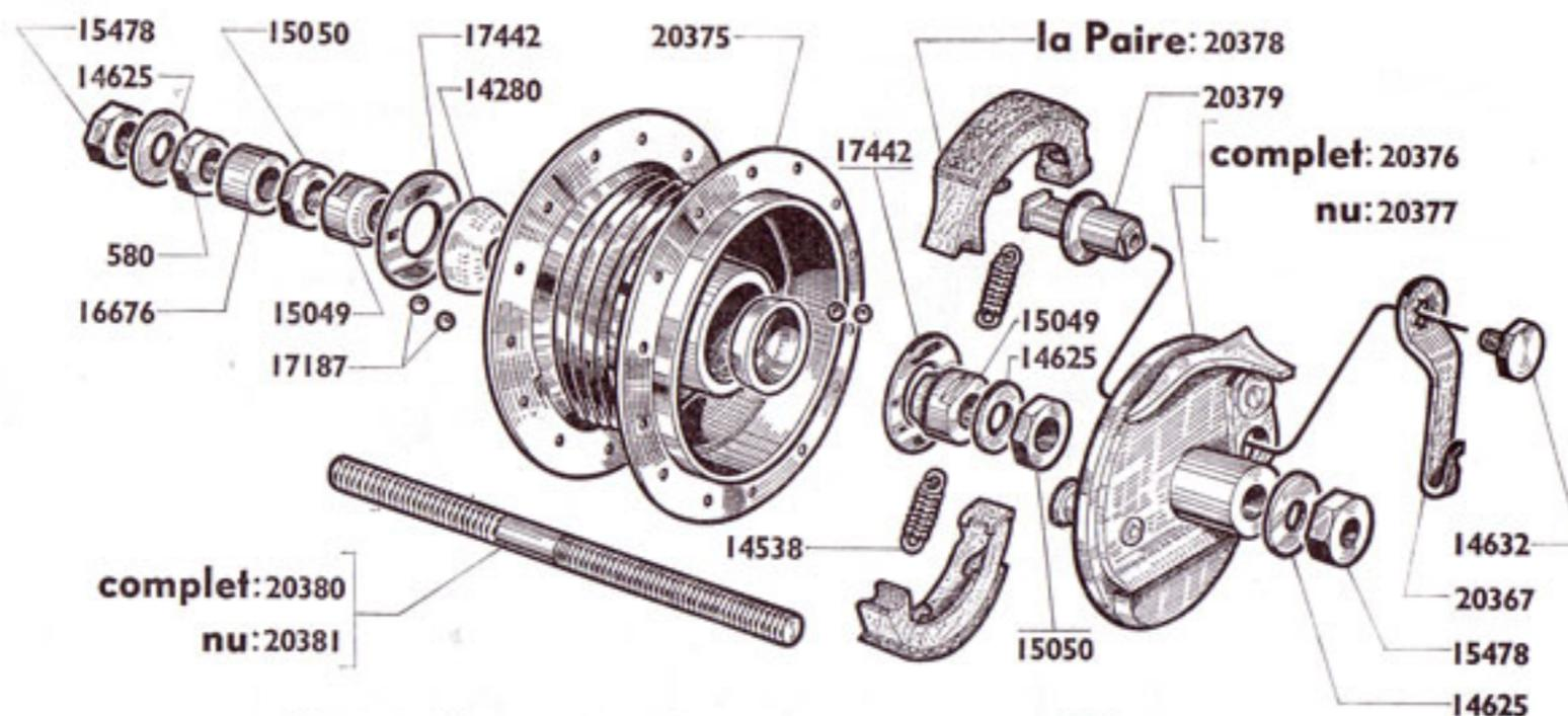
Moyeu Avant complet LELEU  $\varnothing$  70 <sup>m</sup>/<sub>m</sub>: 20346
