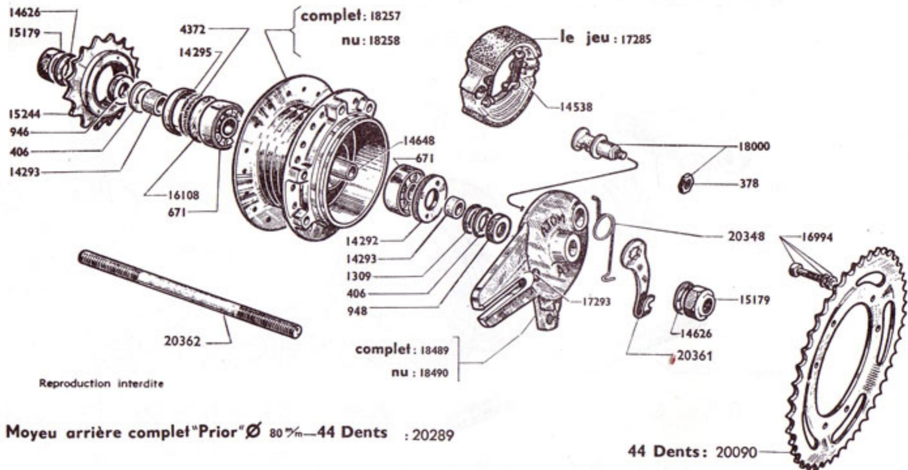
Moyeu arrière complet "Prior" Ø 80  $\frac{m}{m}$  - 44 Dents : 20289
