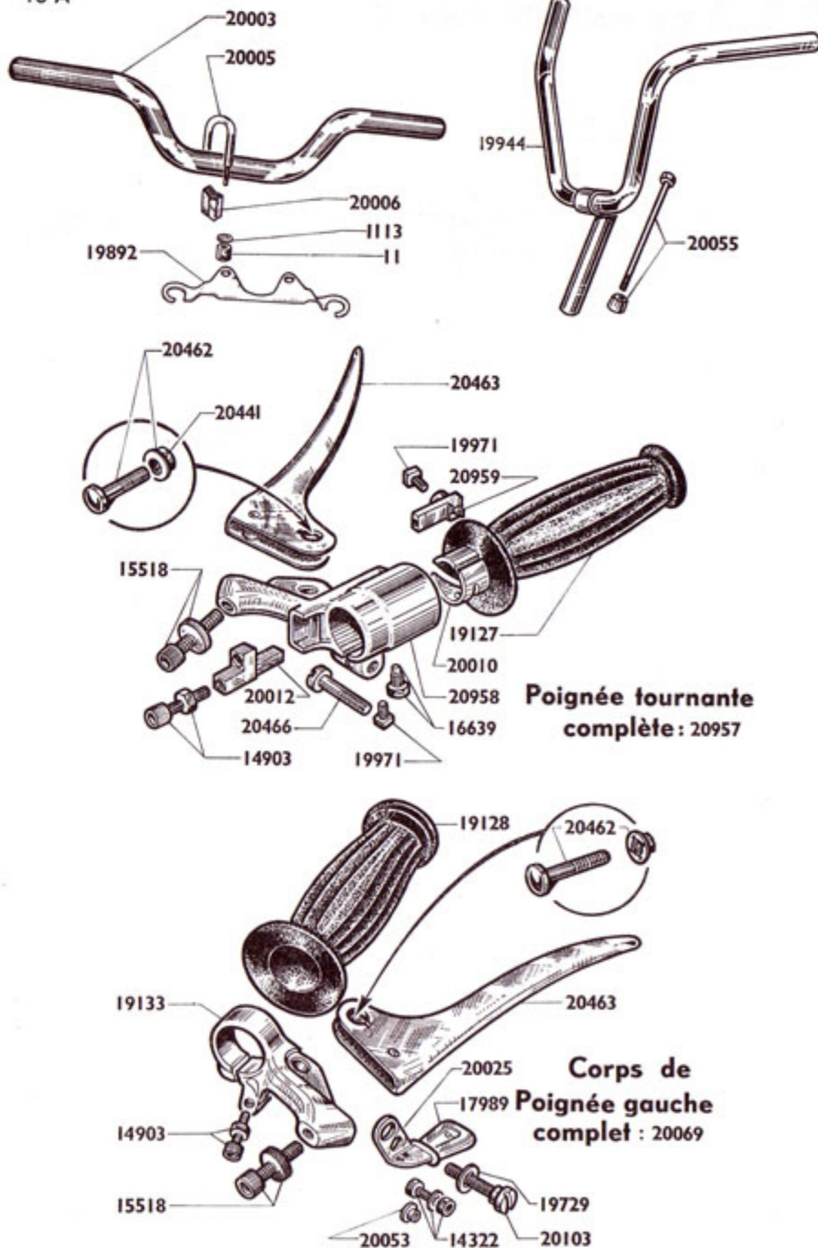
NOTA - Depuis Mai 1970, l'axe de levier n° 20462 (7x100) et l'écrou "TWIX" n° 20441 (7x100) sont remplacés par l'axe de levier n° 20960 (5x80) et l'écrou n° 1511 (5x80). Leviers de frein inchangés.
