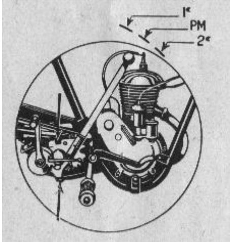
Fig. 12. - Graissage de la boîte de vitesses de la 175 cm<sup>3</sup>
