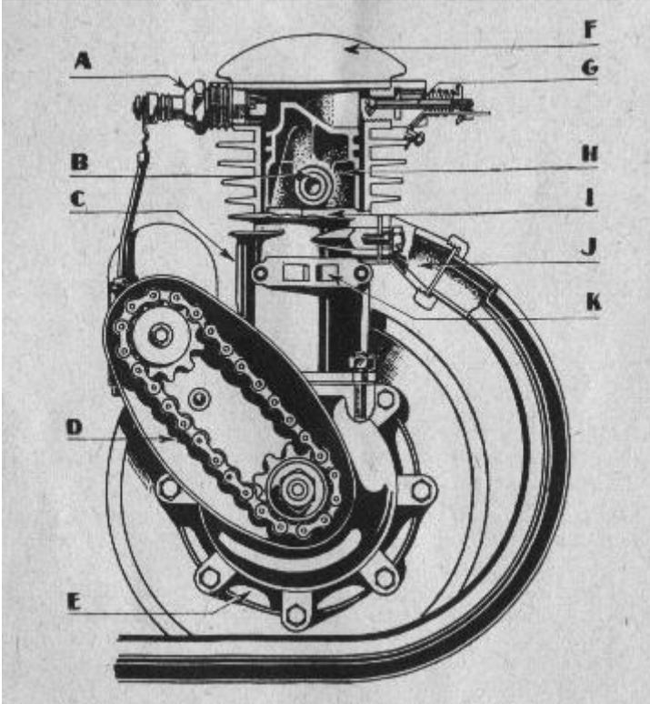
Fig. 4 - Coupe transversale de moteur 2 temps
