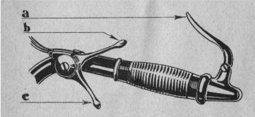
Fig. 7. Partie droite du Guidon de la 308 cm<sup>3</sup>
