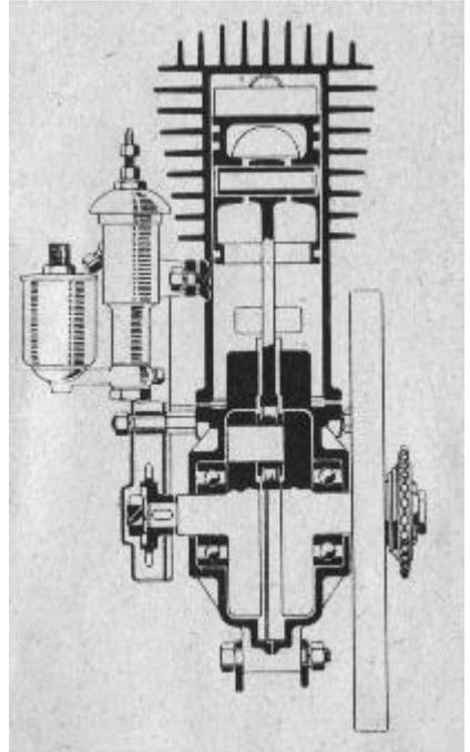
Fig. 5 - Coupe longitudinale du moteur 2 temps
