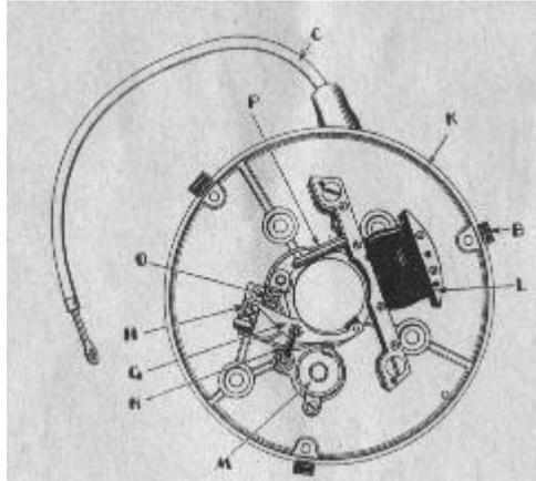
Fig. 17. - Volant magnétique NOVI (capot et Rotor enlevés)
