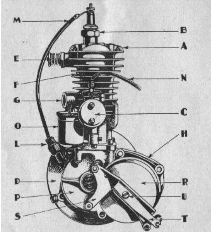
Fig. 1 - Moteur 100 cm<sup>3</sup> à Volant Magnétique
