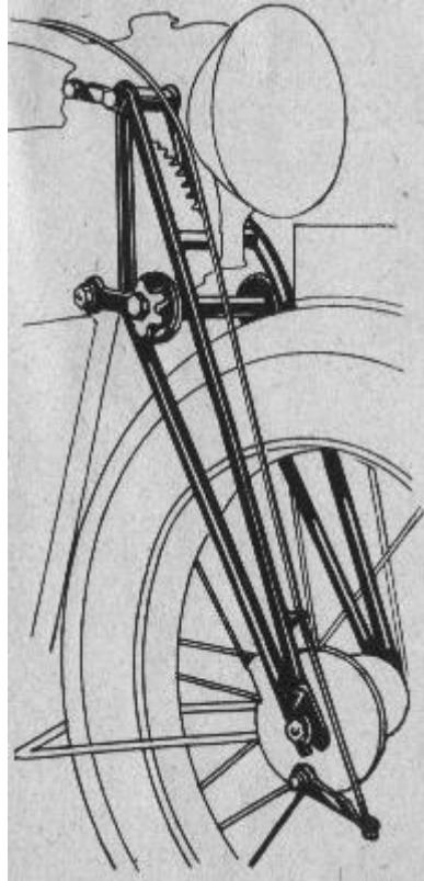
Fig. 14 - Vue de la fourche et de la commande du frein sur roue avant de la 388 cm<sup>3</sup>.
