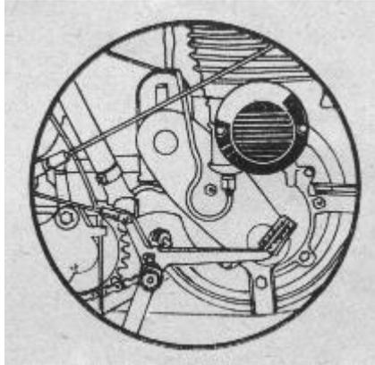
Fig. 19. - Filtre du carburateur de la 308 cm<sup>3</sup>
