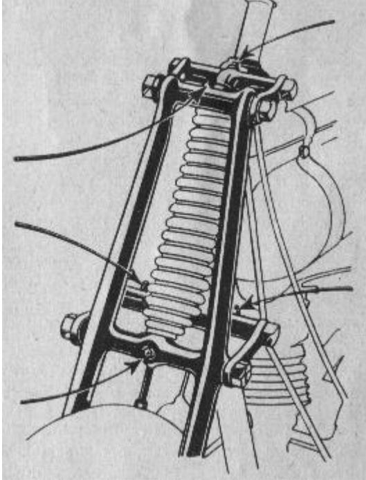
Fig. 18. Graissage de la fourche de la 100 cm<sup>3</sup>
