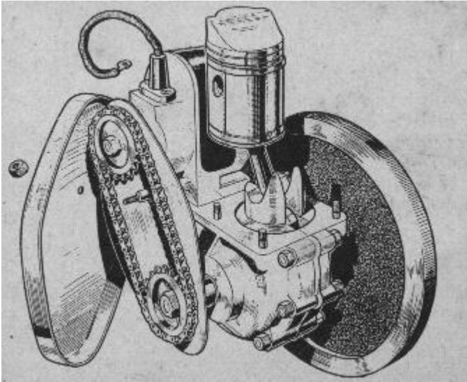
Fig. 10. Moteur (type 175 cm<sup>3</sup>), cylindre et culasse enlevés
