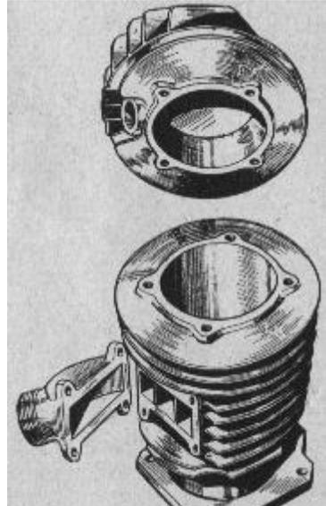
Fig.10. Moteur 175 cm3, cylindre avec culasse et pipe d'admission démontées pour le décalaminage.
