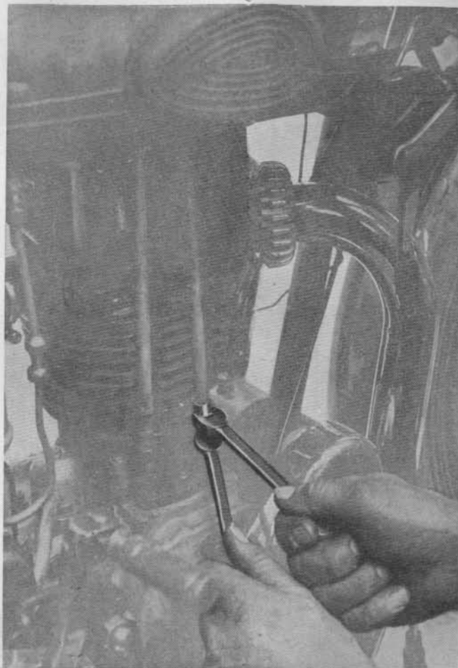
RÉGLAGE DU JEU DES SOUPAPES PAR VIS ET CONTRE-ÉCROU (BLOC-MOTEUR A CULBUTEURS SÉRIE).
